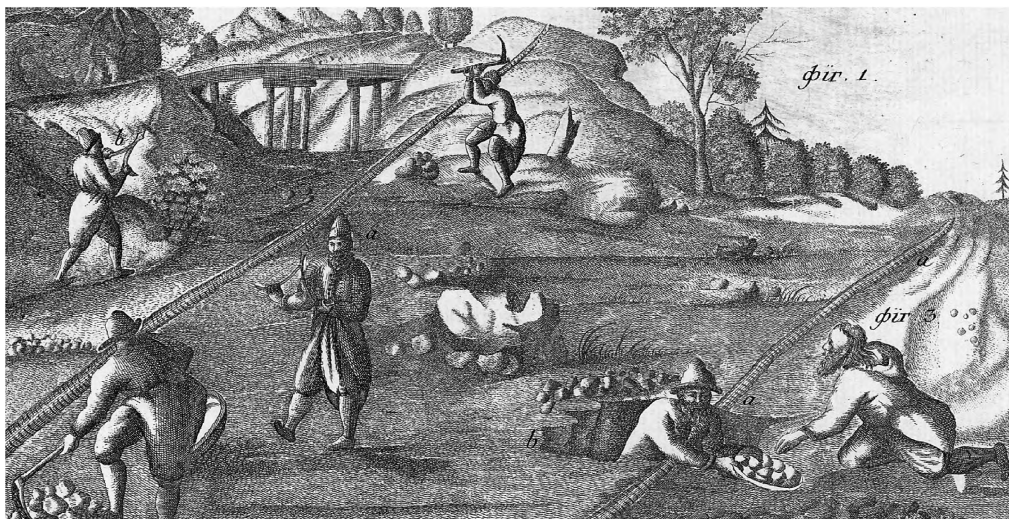
Рис. 2. Поиск руды с помощью лозы и шурфовка.
