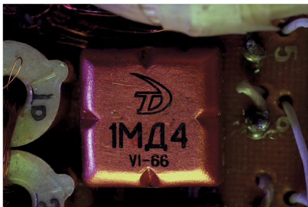
Рис. 3. Интегральная схема «Тропа», Музей микроэлектроники АО «Ангстрем» им. В.В. Григорьевского.
