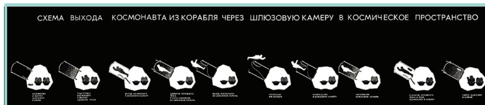
Рис. 11. Схема выхода космонавта из космического корабля через шлюзовую камеру в космическое пространство и возвращения его в кабину. 1965 г. Источник: РГАНТД. Арх. № 4-27.
