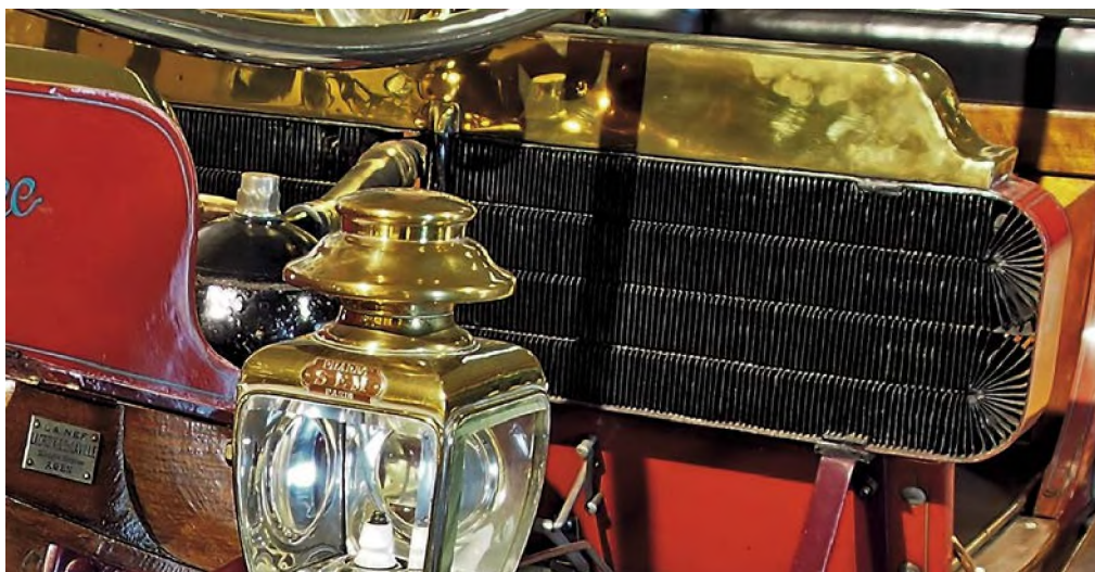
Рис. 5. Радиатор трицикла La Nef (1898 года?), Louwman Museum. Слева видна табличка Lacroix & de Laville Источник: Alf van Beem, Википедия
